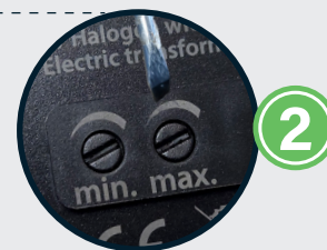
MIN. LICHTNIVEAU INSTELLEN SETTING MIN LIGHT LEVEL EINSTELLUNG DER MINDESTLICHTSTÄRKE RÉGLAGE DU NIVEAU D'ÉCLAIRAGE MINIMUM
